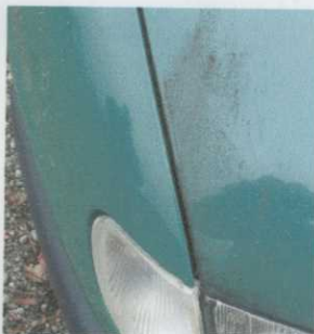
Obr. č. 1. Kapota, poškození laku PP roh
