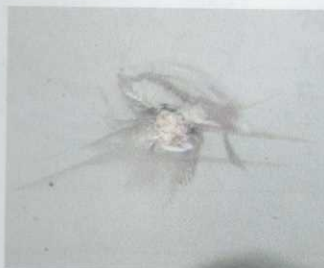
Obr. č. 2. Čelní sklo, proražené a prasklé
