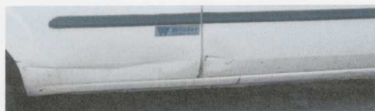
Obr. č. 2. Poškození PP a PZ dveří vozidla
